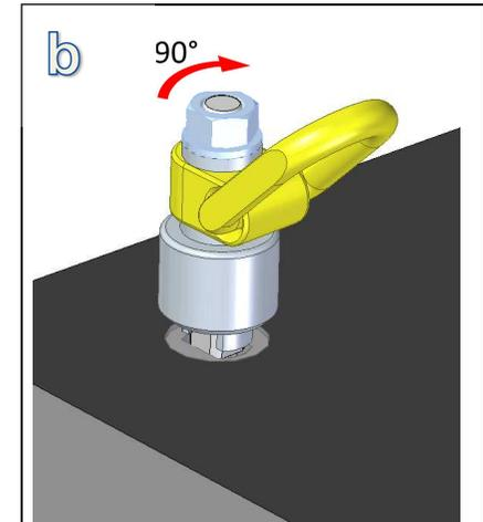
Nockenschraube so weit einführen bis der GATIC plus Schachttöffner um 90° gedreht werden kann. In dieser Position die Verdrehsicherung loslassen.
