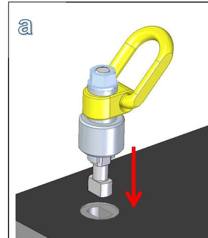
Nockenschraube in Langloch einführen, dabei die Verdrehsicherung in der oberen Position festhalten.
