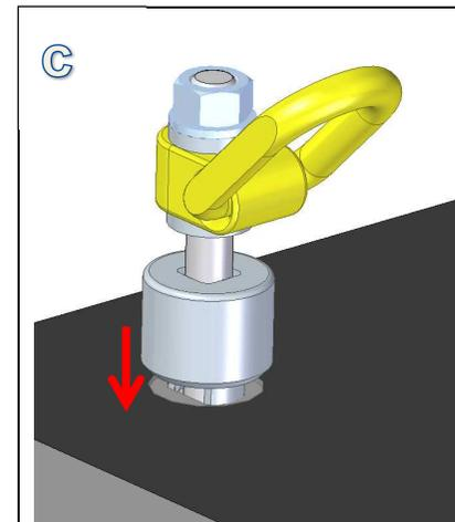
Die Klauen der Verdrehsicherung müssen dabei in das Langloch eingeführt werden. Die Schulter der Verdrehsicherung muss auf dem Schachtdeckel aufliegen.
