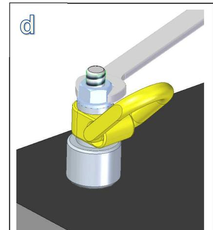
Die Mutter mit einem Schraubenschlüssel (SW24) satt festziehen. Somit ist der Schachttöffner verdrehsichert und fest mit dem Schachtdeckel verbunden.
